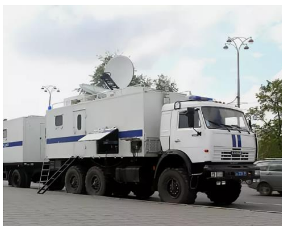
Рис. 3. Подвижный узел связи «5027А1» на шасси КАМАЗ-43118
